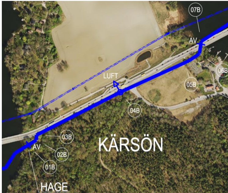
Bild 2: Kärösön ny HV1200 söder om Ekerövägen och befintliga HV900 respektive HV1000 norr om Ekerövägen.
