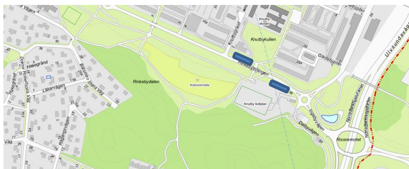
Figur 9 Förlängda och tillgänglighetsanpassade hållplatser längs Rinkebysvängen. En ny mittrefug mellan hållplatserna förhindrar omkörning.
