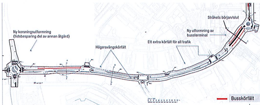
Figur 3-1 Utformningsprincip för Bollmoravägen
