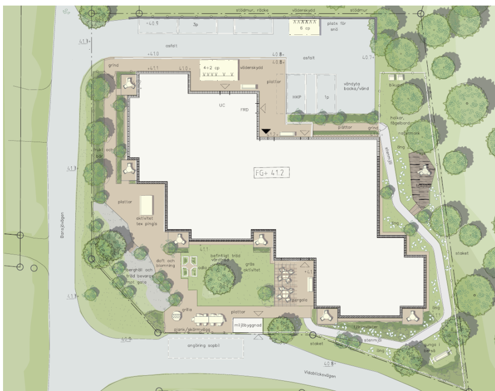
Föreslagen markplanering för Näsbjälagen 4:1032. Förslag på placering och utformning aktivitetsytor och plantering har vidareutvecklats i det kvalitetsprogram som togs fram inför granskningskedet.
