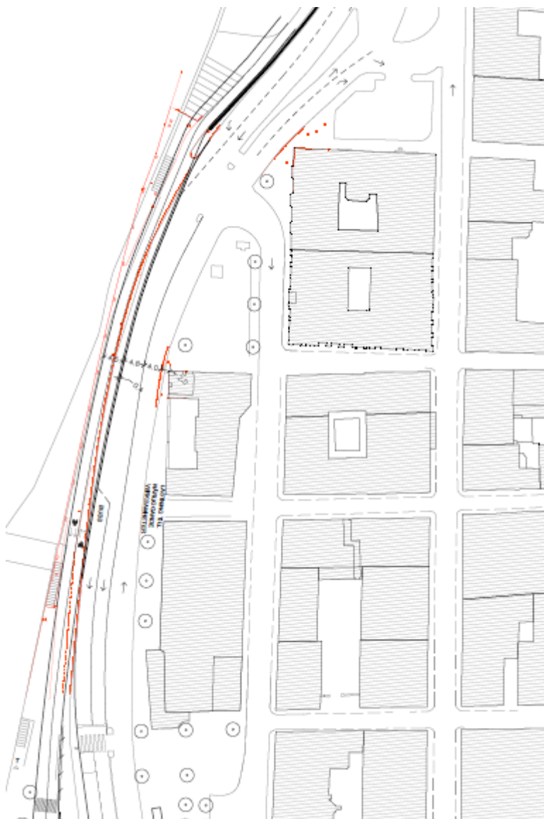
Figur 13. Breddning av cykelbana söder om Riddarholmskanalen.
