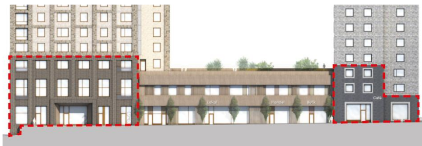
Fasadritning som visar exempel på markerade sockelmotiv. Sockelmotiv i tre våningar till vänster. Till höger varierar sockelmotivet i tre till en våning. (Bergkrantz)
