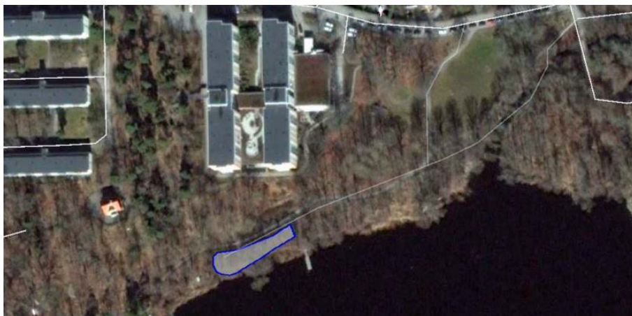
Figur 28. Förslag till placering av en dagvattendamm vid Nordmarksvägen på knapp 0,06 hektar (vätyta), vilket motsvarar cirka 0,8 % av avrinningsområdets reducerade yta.
