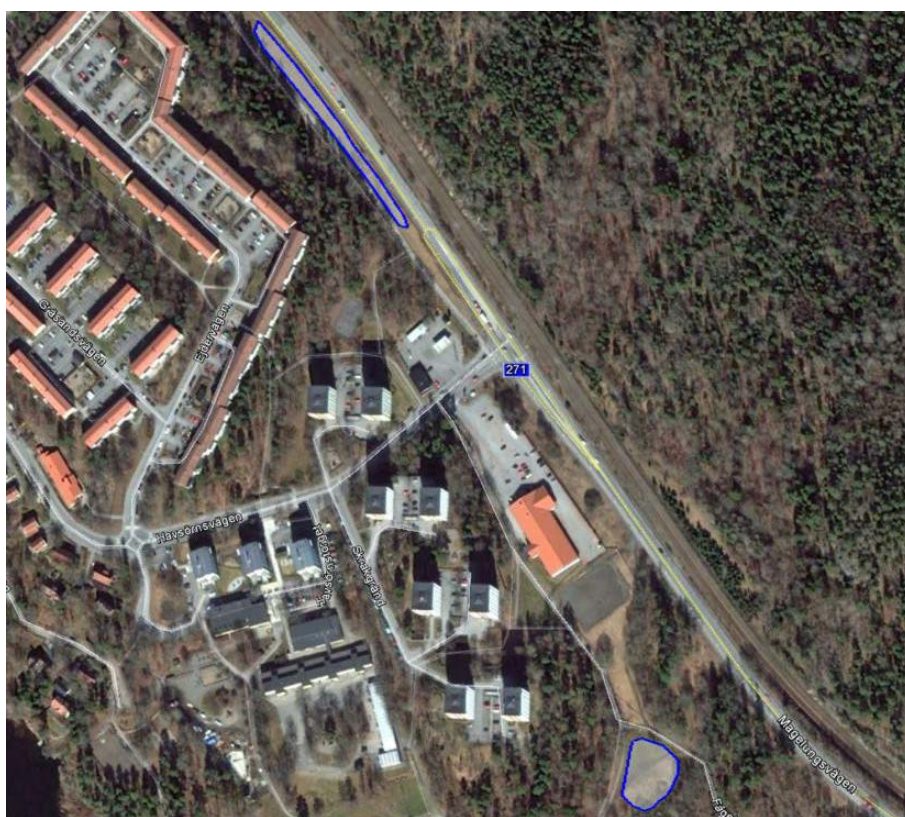
Figur 24. Två förslag till placering av dagvattendammar vid Magelungsvägen respektive Fågelviksbacken på knapp 0,2 hektar (våtyta) vardera, vilket tillsammans motsvarar cirka 1 % av avrinningsområdets reducerade yta.
