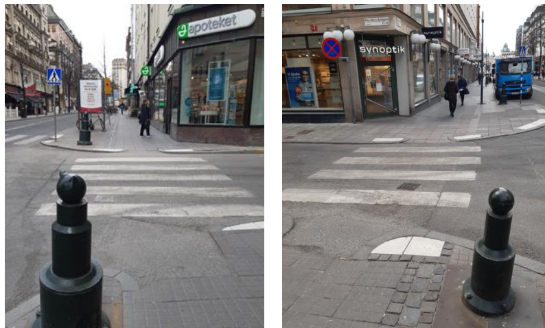
Figur 13. Dagens anslutningar från Kungsgatan vid Målargatan till vänster i bild och Klara Norra Kyrkogata till höger, byggs om till tydliga entréer med genomgående gångbanor längs med Kungsgatan.
