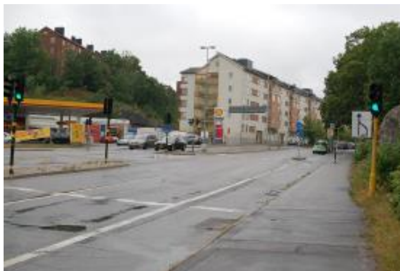
Figur 3. Korsningen Hägerstensvägen/Kilabergsvägen. Cyklister ges röd signal trots att de inte berörs av korsande trafik.
