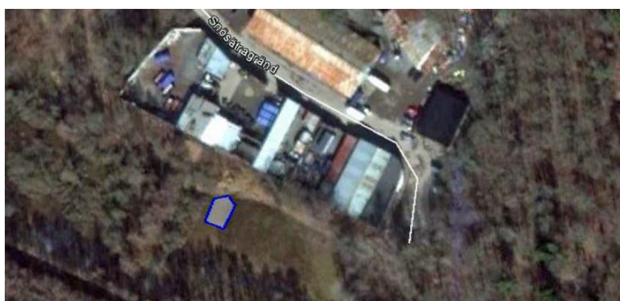
Figur 50. Förslag till placering av en dagvattendamm vid Snösättra på 0,01 hektar (våtyta), vilket motsvarar cirka 1 % av avrinningsområdets reducerade yta.
