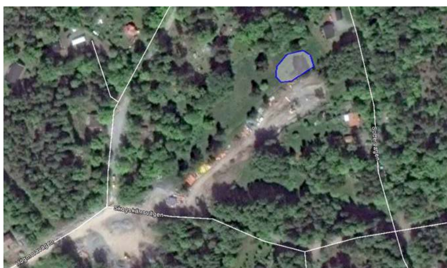
Figur 13. Illustration av ytbehov och möjlig placering av en dagvattendamm vid Högmoravägen på 0,04 hektar (våtyta), vilket motsvarar cirka 1 % av avrinningsområdets reducerade yta.
