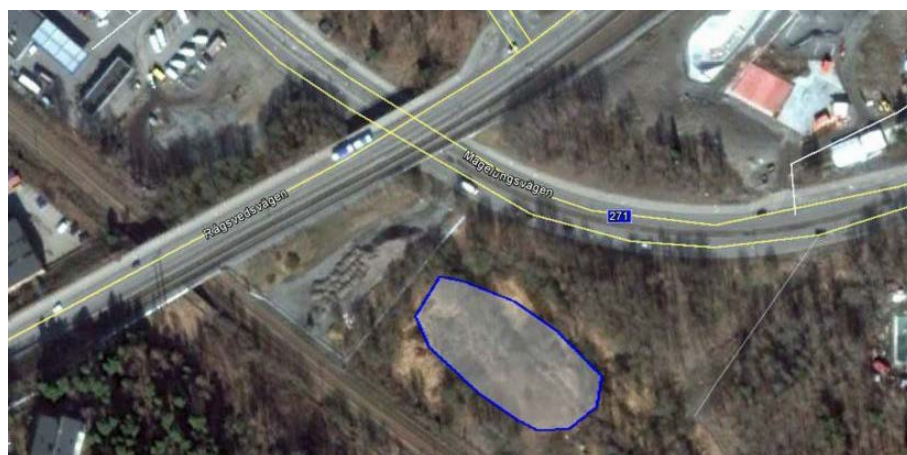
Figur 17. Illustration av ytbehov och ungefärlig placering av en dagvattendamm nedanför Rågsvedsvägen på 0,3 hektar (våtymta), vilket motsvarar cirka 1 % av avrinningsområdets reducerade yta.
