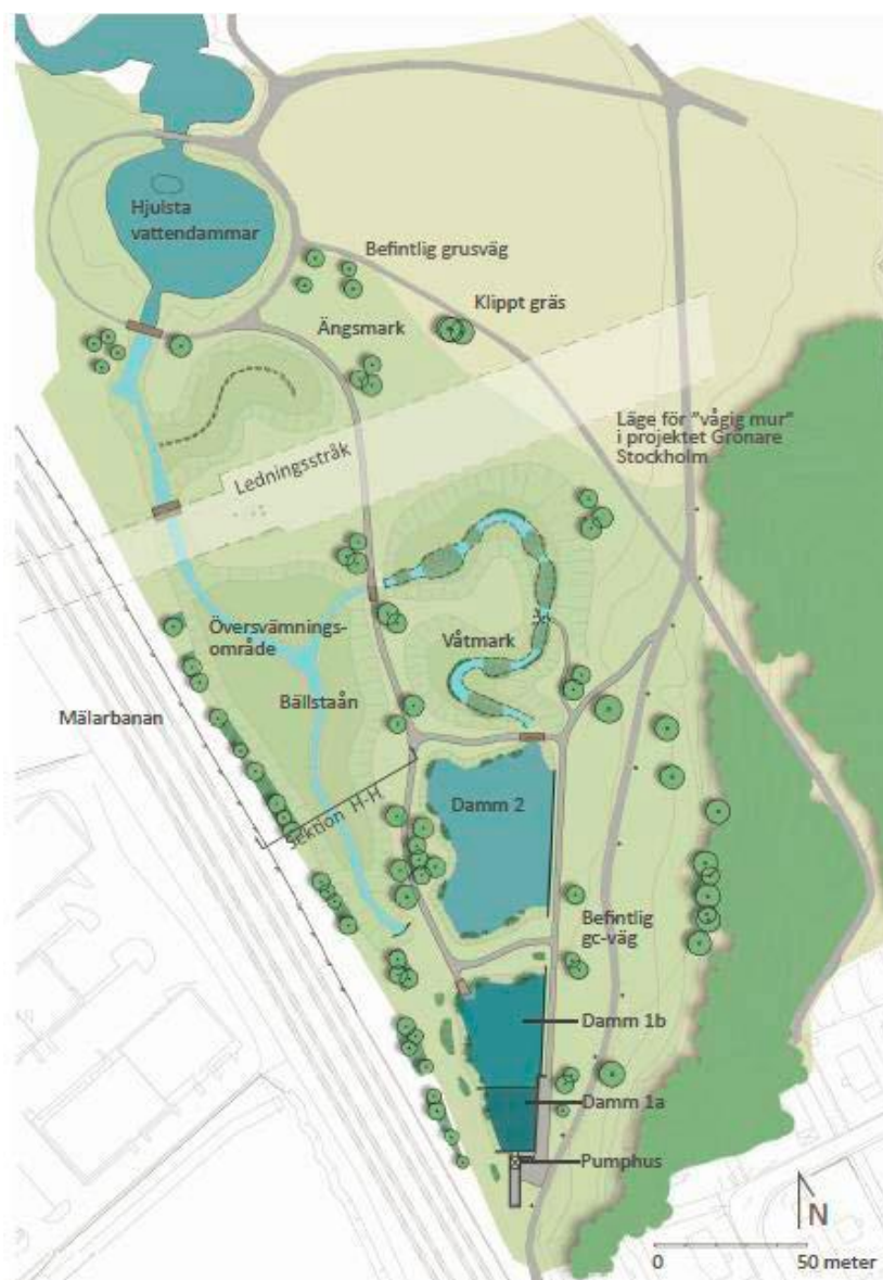
Illustrationsplan som visar det föreslagna dammsystemet som utgör Tensta dagvattenpark.
