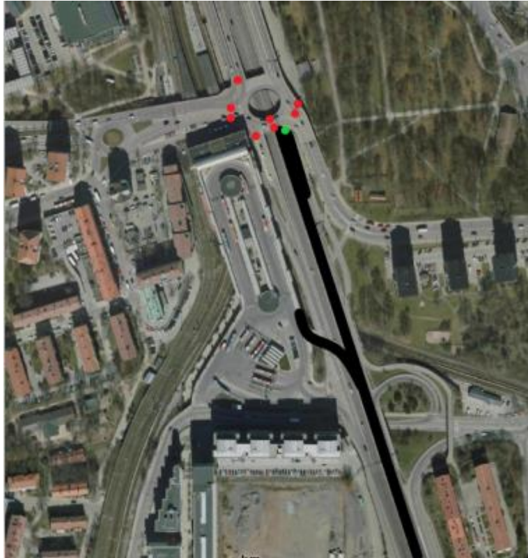
Figur 5. Föreslagen ramp med nytt hållplatsläge vid Gullmarsplan på Nynäsvägen norrut. De röda och gröna punkterna symboliserar föreslagna trafiksignaler.
