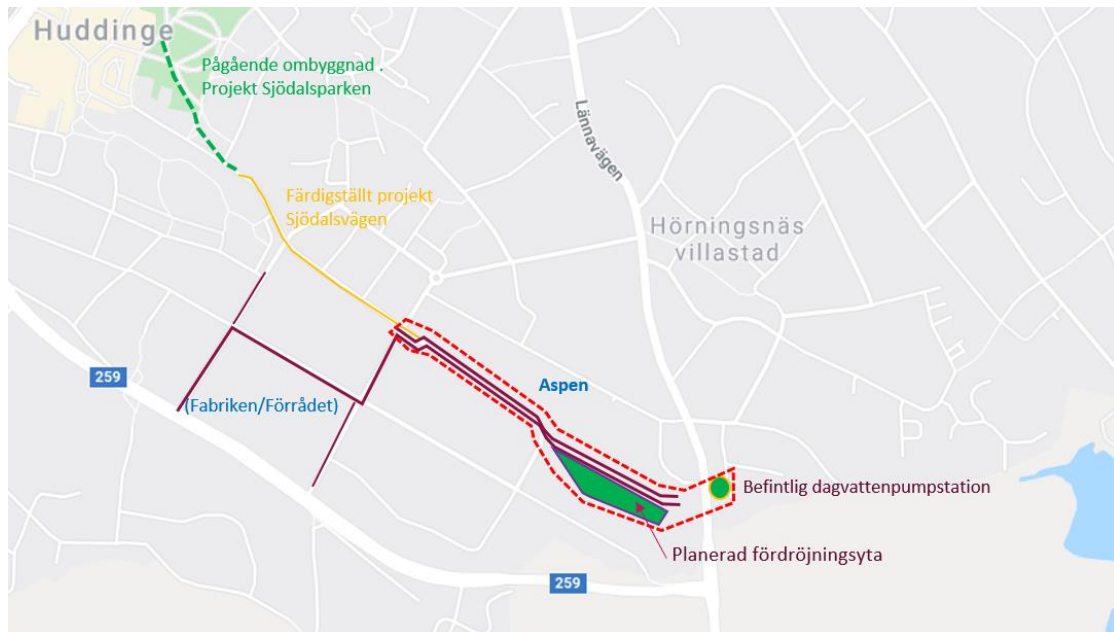
Figuren avser ungefärlig utbredning av Aspen och schematisk illustration av SVOAs nya ledningar, ny fördröjningsyta och utbyggnad av pumpstation i exploateringsprojekt Aspen.
