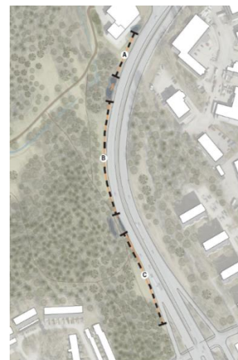
Figur 6. Bullerskyddsskärmens sträckning uppdelad på tre sektioner (LAND, 2020)
