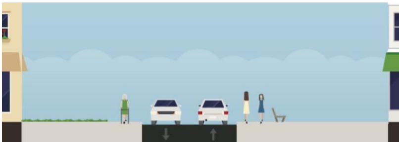
Principsektion Apelvägen, vy från väster (11,5 m): Gångbana (3,0 m), körbana (6,5 m) och gångbana (2,0 m). Källa: Tyresö kommun 2018, Streetmix©
