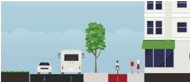
Principsektion Prästgårdsvägen, vy från söder (13,8 m): Körbana (6,5 m), yta för lämning och uppställning av sopbil (3,0 m), GC-väg (2,3 m) och gångbana (2,0 m). Källa: Tyresö kommun 2018, Streetmix©
