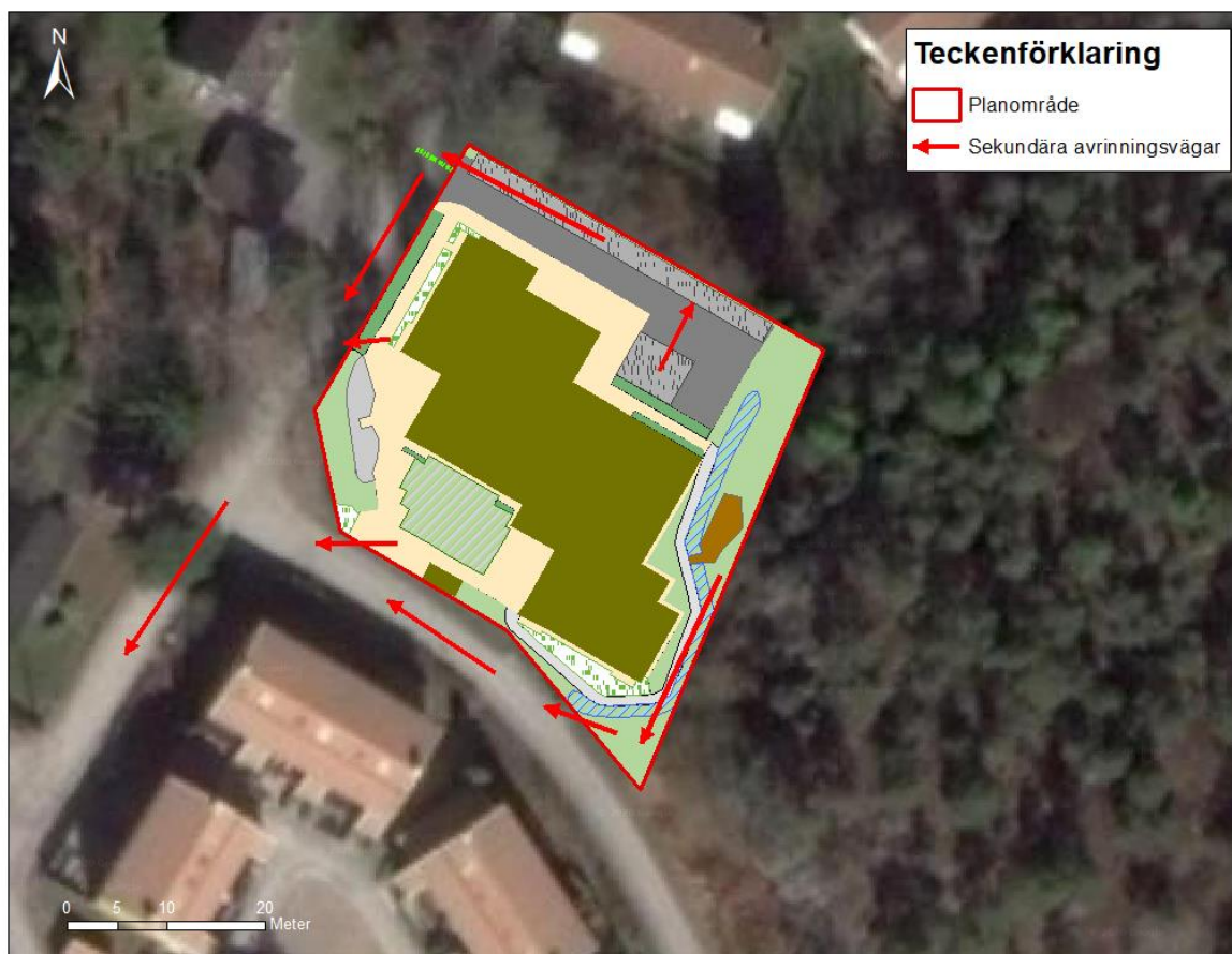
Figur 7-1. Sekundära avrinningsvägar från planområdet i samband med att dagvattenlösningarnas och kapacitet överskrids.
