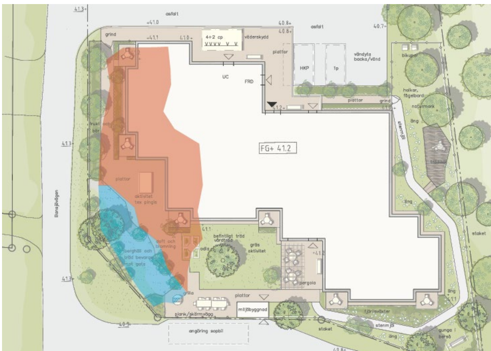
Illustrationsplan där röd markering visar del av berg i dagen som ska sprängas bort. Blå markering visar berg i dagen som sparas. Gränserna för berg i dagen är ungefärliga.
