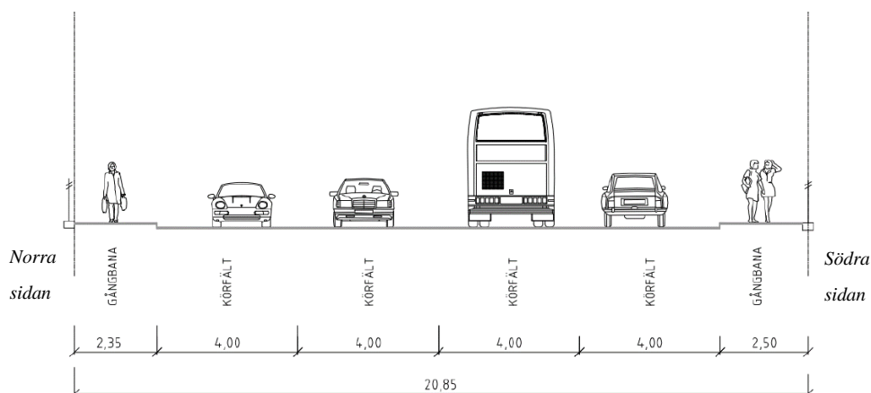
Figur 6, befintlig sektion på Bällstabro.
