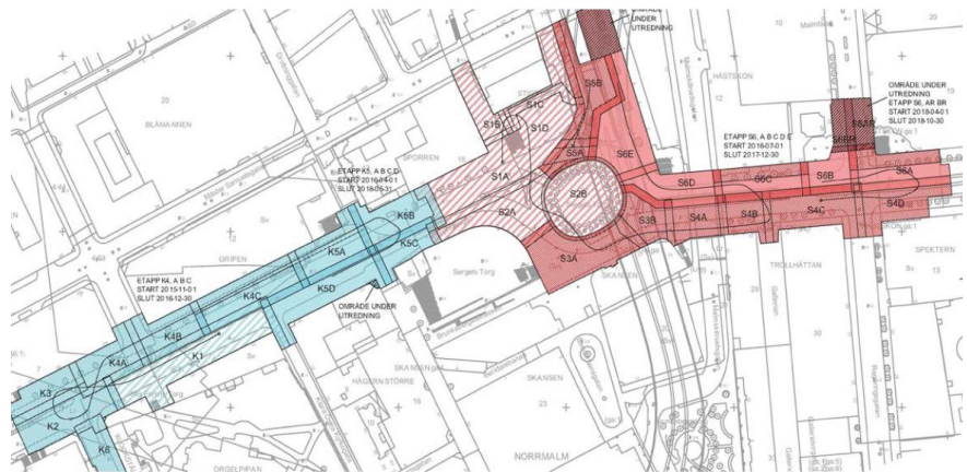
Figur 16. Projektområdet indelat på 27 etapper. De röd-randiga etapperna ingick i del 1. De blåa och röda etapperna ingick i del 2.
