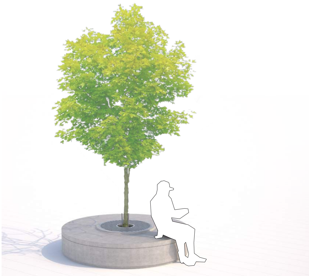
Princip för utformning av upphöjd trädplantering med sittmöjlighet.
