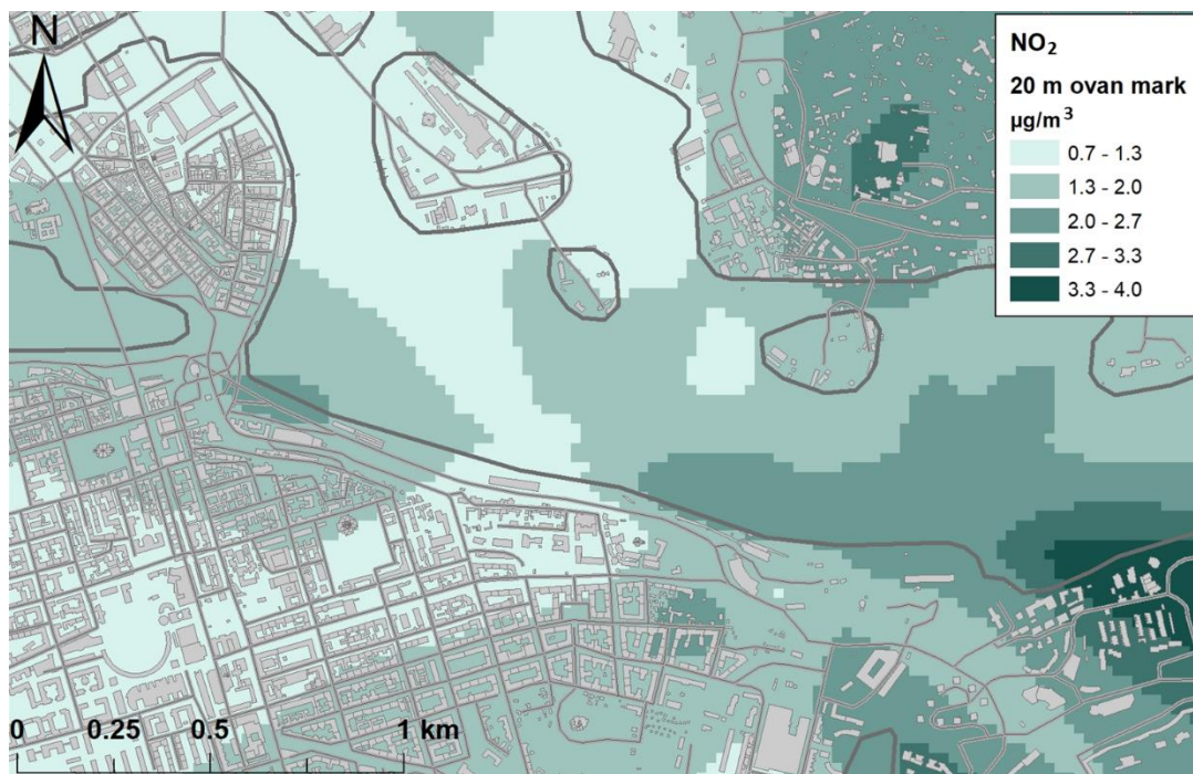
Figur 5. Beräknad medelhalt av kvävedioxid, NO 2 (µg/m 3 ) från kryssningstrafiken. Halterna gäller 20 m ovan mark för ett meteorologiskt normalår. Normvärdet som ska klaras är 40 µg/m 3 . (Observera att detta inte är den totala halten utan enbart från kryssningstrafiken)
