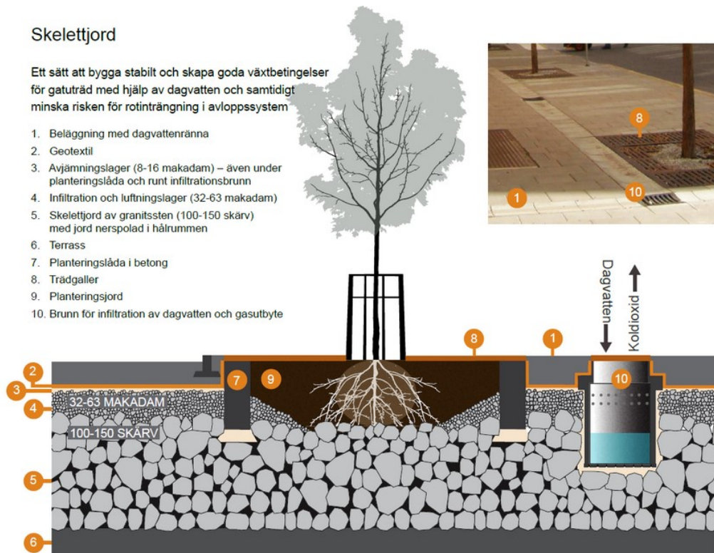
Figur 24. Principskiss för skelettjord. Bild: Stockholms stad (2017).
