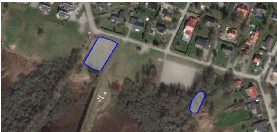
Figur 23. Illustration av ytbehov och ungefärlig placering av dagvattendammar vid Kaninholmen på drygt 0,2 hektar (våtyta), vilket motsvarar cirka 1 % av avrinningsområdets reducerade yta.
