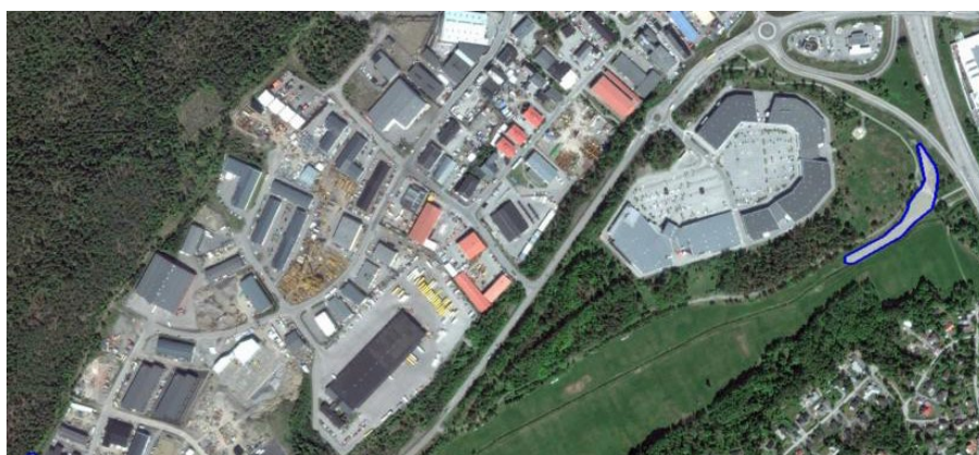
Figur 8. Illustration av ytbehov och ungefärlig placering av dagvattendammar vid Länna industriområde på sammanlagd 0,55 hektar (våtyta), vilket motsvarar cirka 1 % av avrinningsområdets reducerade yta.
