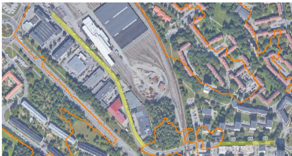
Figur 7. Åtgärd C6, avrinningsområde till växtbäddar (gul yta) och gräns för tillrinningsområdet till Räcksta trask (orange linje). Figur baserat på GIS-underlag från Sweco 2017, se referenser.
