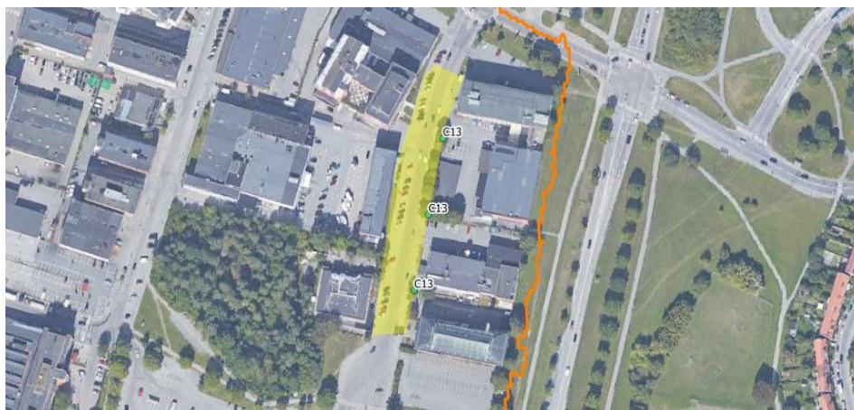
Figur 15. Åtgärd C13 (grön yta), avrinningsområde till växtbäddar (gul yta) och gräns för tillrinningsområdet till Räcksta trask (orange linje). Figur baserat på GIS-underlag från Sweco 2017, se referenser.
