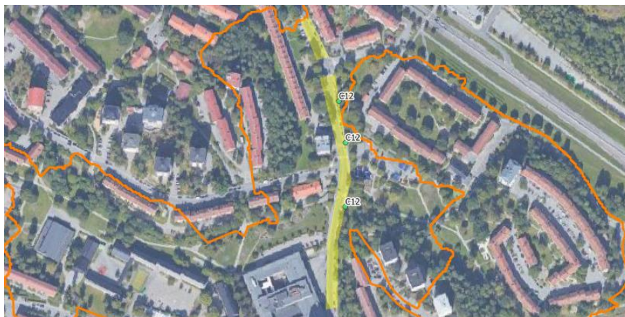
Figur 14. Åtgärd C12 (grön yta), avrinningsområde till växtbäddar (gul yta) och gräns för tillrinningsområdet till Räcksta träsk (orange linje). Figur baserat på GIS-underlag från Sweco 2017, se referenser.
