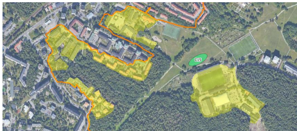
Figur 17. Åtgärd C15 (grön yta), avrinningsområde till torrdamm (gul yta) och gräns för tillrinningsområdet till Räcksta träsk (orange linje). Figur baserat på GIS-underlag från Sweco 2017, se referenser.
