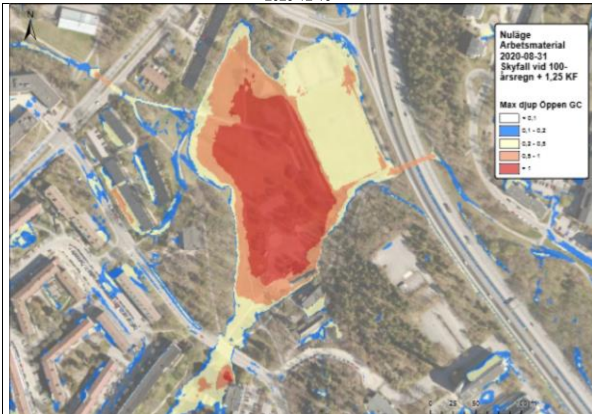
Figur 3 Fördjupad skyfallsinventering, djup, arbetsmaterial i närliggande detaljplaneprojekt, innan byggnation. Kommentar till detaljeringsnivån: Här har bland annat en mer korrekt bild kunnat tas fram genom att broar uppströms inte är ett hinder för vatten i modellen.
