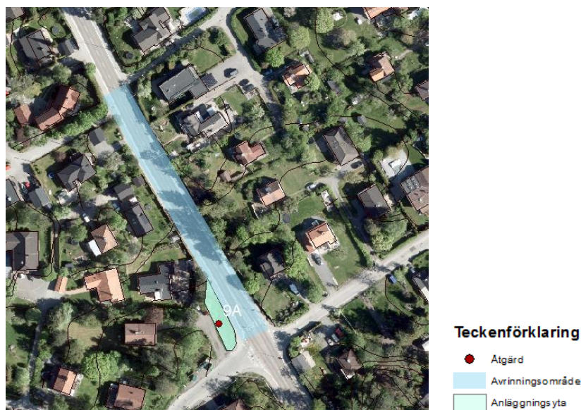
Figur 11. En del av avvattningen från Häradsvägen kan ledas till en växtbädd bredvid vägen som idag utgörs av en gräsyta.
