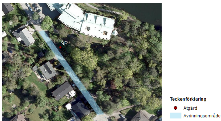
Figur 12. Del av Tranvägen kan avvattnas till ett skogsparti bredvid sjön genom att vägen skevas om.
