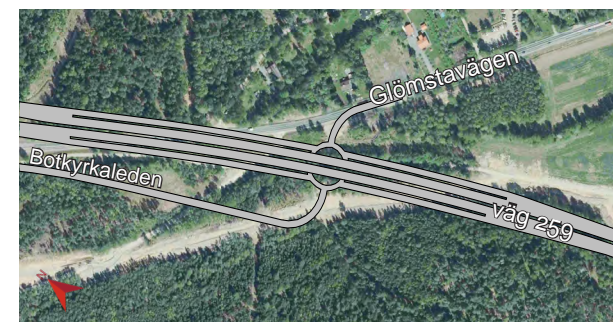
Figur 3.55 Alternativ utformning med cirkulationsplats under väg 259.
