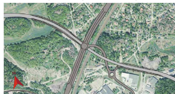
Figur 3.65 Alternativ utformning med trafikplats i två plan med cirkulationsplats och väg 259 överst och väg 226 underst.
