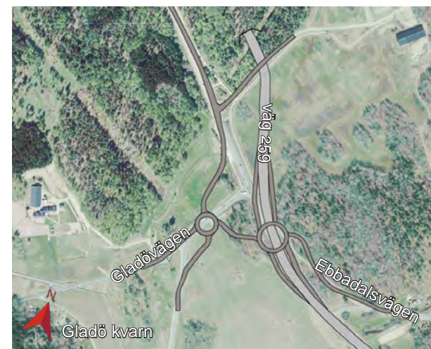
Figur 3.73 Alternativ placering med trafikplats vid Gladövägen (G5) med ruterramper, cirkulationsplats över väg 259 och koppling till nordligt läge för Flemingsbergstunnels mynning (F3).
