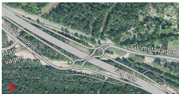
Figur 3.53 Alternativ utformning med kompakt dubbeldroppe över väg 259 i västligt läge.
