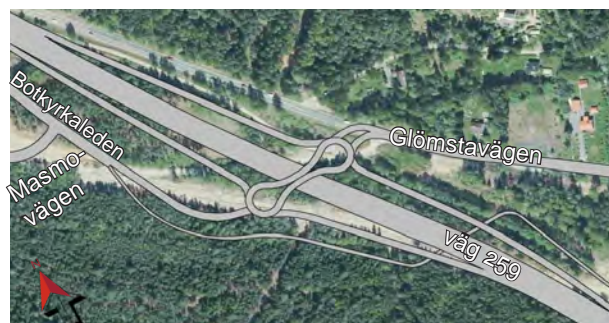
Figur 3.54 Alternativ utformning med kompakt dubbeldroppe över väg 259 i östligt läge.
