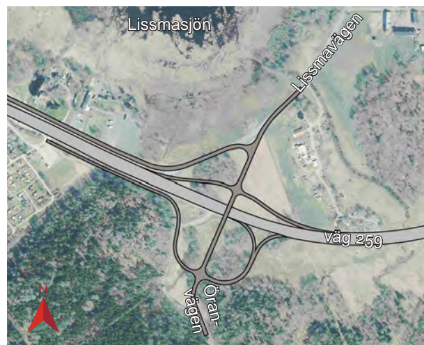
Figur 3.78 Alternativ utformning för trafikplats Lissma med lokalväg på bro över väg 259 med klöver- och ruterramper.
