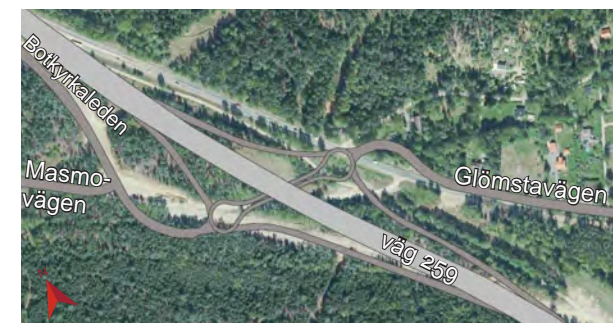
Figur 3.57 Alternativ utformning med utdragen dubbeldroppe under väg 259.
