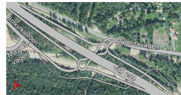
Figur 3.56 Alternativ utformning med kompakt dubbeldroppe under väg 259.
