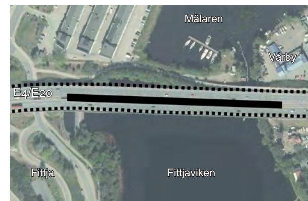
Figur 3.49 Alternativ utformning för Vårbybron med vägren som nytt körfält (streckad svart linje) samt hopgjutning (heldragen svart linje).
