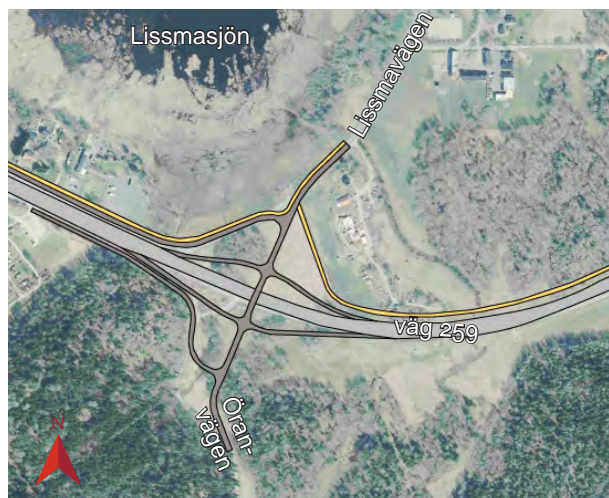
Figur 3.79 Alternativ utformning för trafikplats Lissma med lokalväg på bro över väg 259 med ruterramper.
