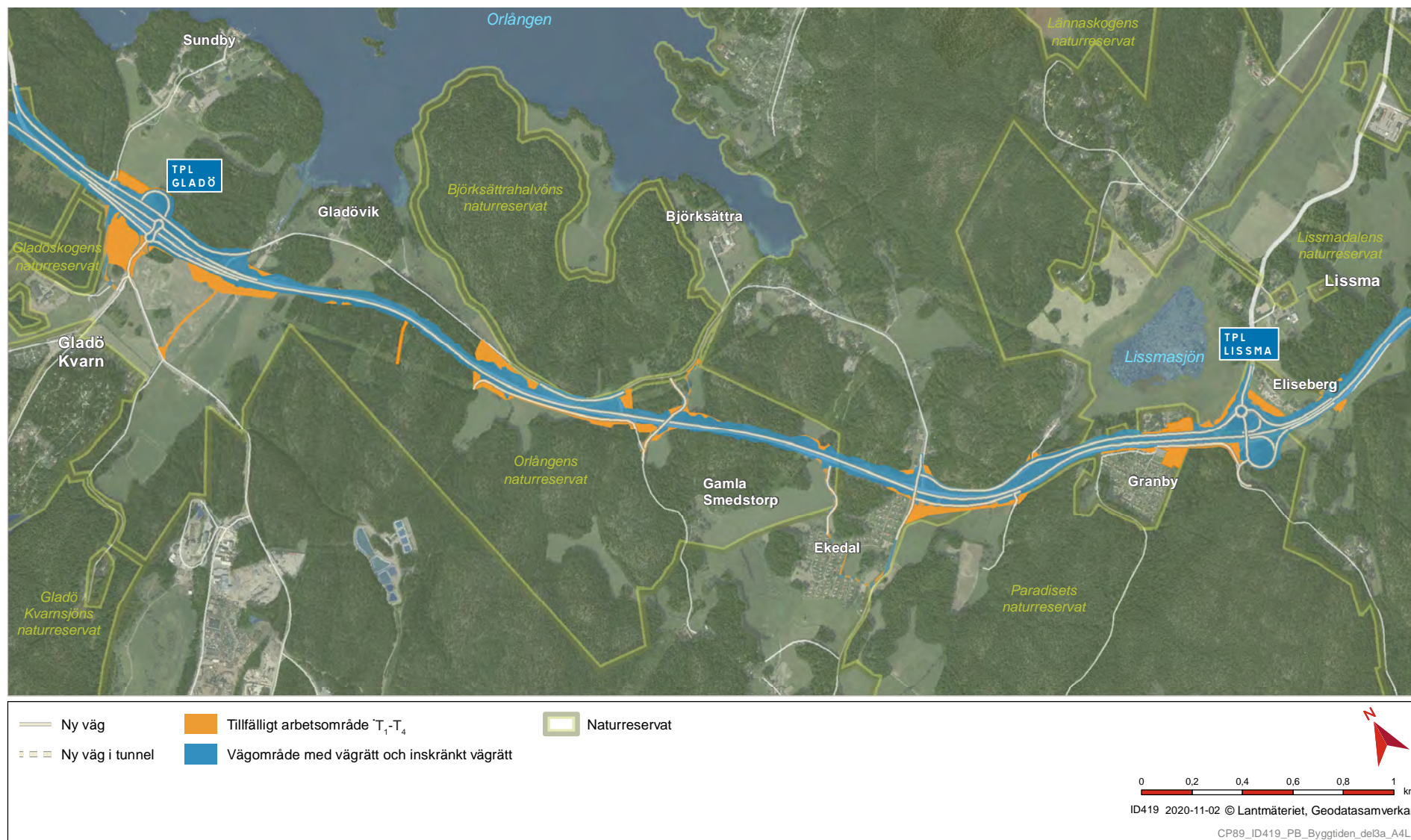
Figur 3.46 Anläggningar under byggskedet, sträckan Gladö kvarn-Lissma.
