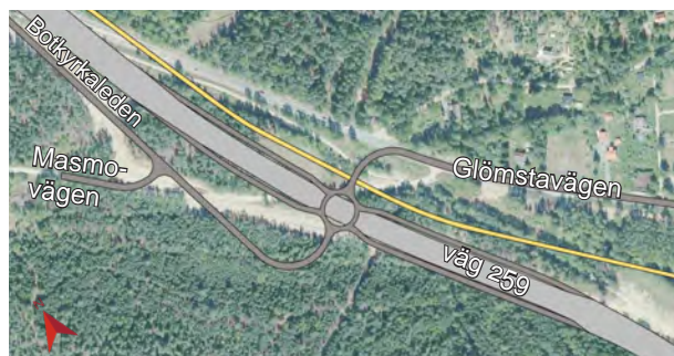
Figur 3.52 Alternativ utformning med cirkulationsplats över väg 259 i östligt läge.
