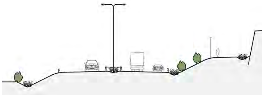
Figur 3.7 Gång- och cykelväg belägen på högre nivå än väg 259.
