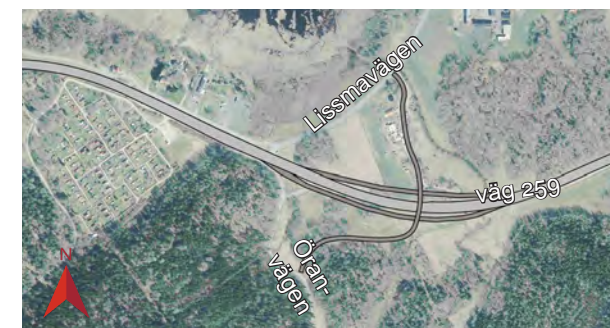
Figur 3.82 Alternativ utformning för trafikplats Lissma med anslutning till Lissmavägen genom Elisebergs gård.
