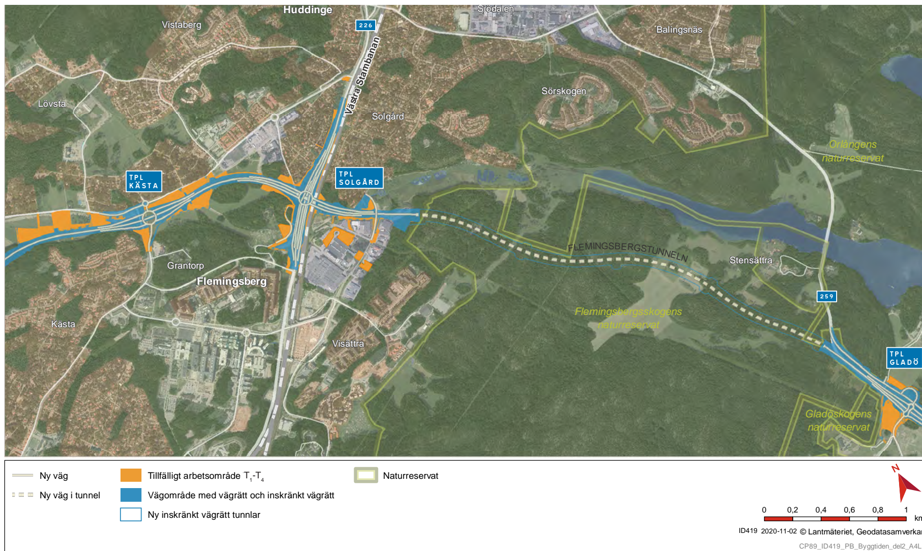
Figur 3.45 Anläggningar under byggskedet, sträckan Glömsta-Gladö kvarn.
