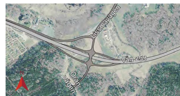
Figur 3.80 Alternativ utformning för trafikplats Lissma med dubbeldroppe över väg 259 och ruterramper.
