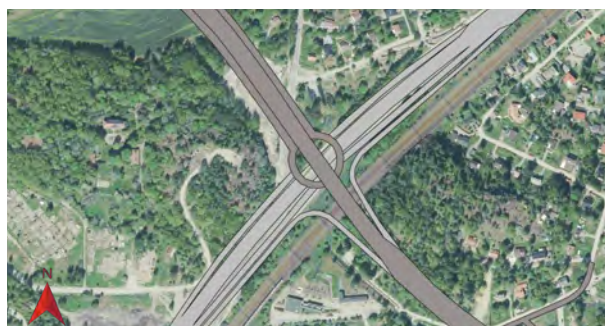
Figur 3.62 Alternativ utformning med trafikplats i tre plan med cirkulationsplats i mitten, väg 226 underst och väg 259 överst.
