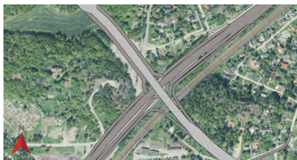
Figur 3.63 Alternativ utformning med trafikplats i tre plan med cirkulationsplats underst, väg 226 i mitten och väg 259 överst.
