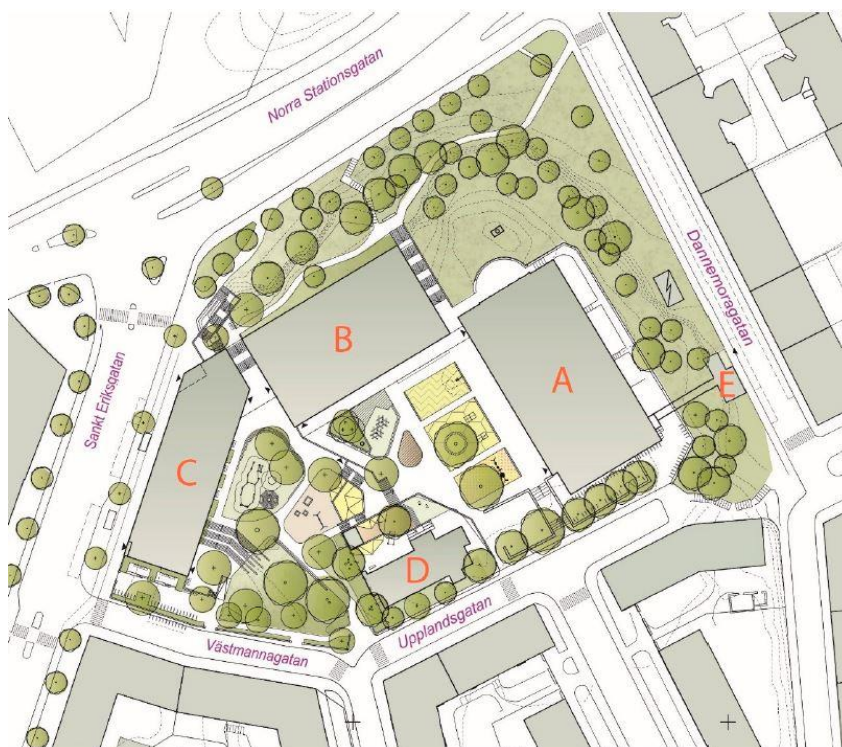
Figur 3 - Situationsplan över Rödabergsskolan. Hus A är befintlig skolbyggnad från 1953. Hus B, C och E är tillkommande skolbyggnader. Hus D är befintlig skolbyggnad från 1977.
