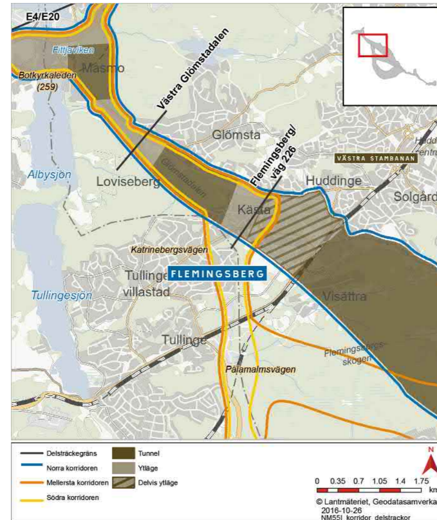
Figur 6.15. Delsträcka 2, Norra korridoren tunnel.
