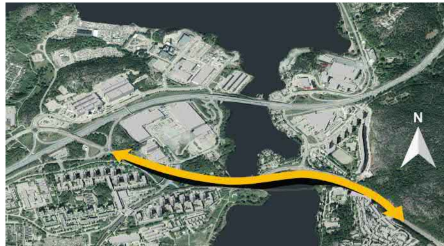
Figur 6.11. Förslag på anslutning mot E4/E20 via Fittja, där vägen går i ytläge genom Fittja med bro över Albysjön.
