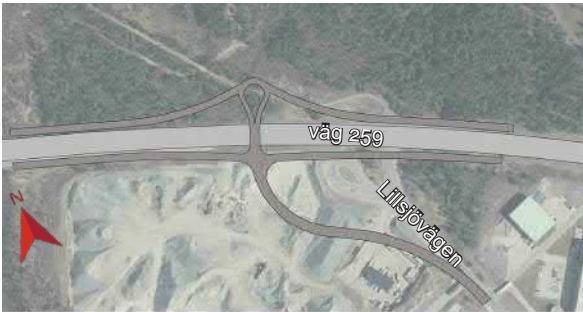
Figur 3.70 Trafikplats Rudan, ruterramper och enkeldroppe.
