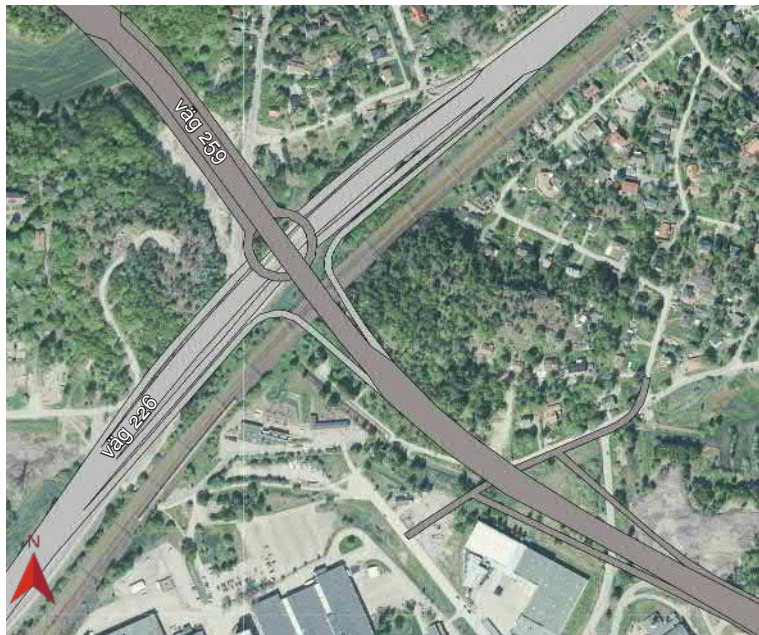
Figur 3.30 Trafikplats Solgård i tre plan med väg 259 på översta planet.
