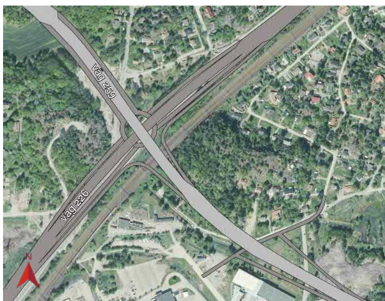
Figur 3.31 Trafikplats Solgård, utformas i tre plan. Cirkulation under väg 226, väg 259 överst.
