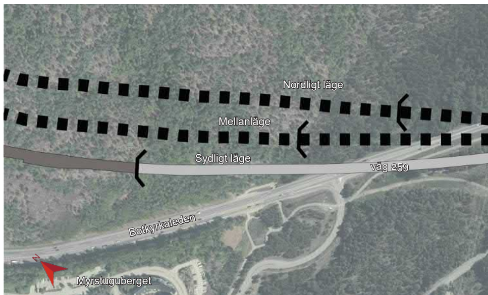
Figur 3.9 För Masmotunnelns södra mynning har två alternativa placeringar avförts: alternativ Nord och alternativ Mellan. De redovisas med streckad linje. Valt alternativ visas med mörkgrå och ljusgrå linje.
