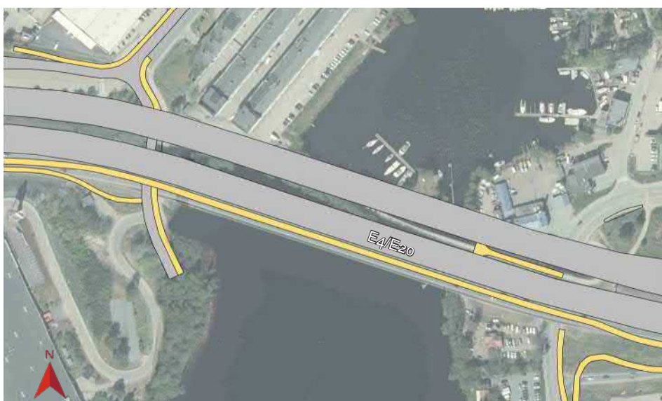
Figur 3.7 Nya brokonstruktioner för Vårbybron anläggs i samma läge som befintlig bro och med en breddning norrut.
