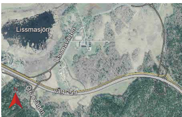
Figur 3.65 Trafikplats Lissma med klöverramper i bergskärning, (13).
