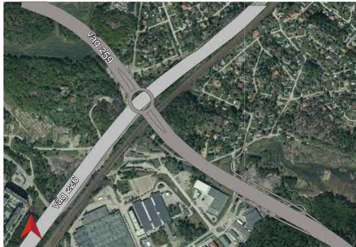
Figur 3.32 Trafikplats Solgård i två plan, väg 259 med cirkulation i samma plan.
