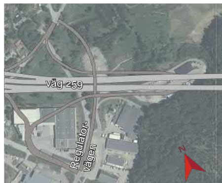
Figur 3.37 Trafikplats med klöverramper vid Regulatorvägen.
