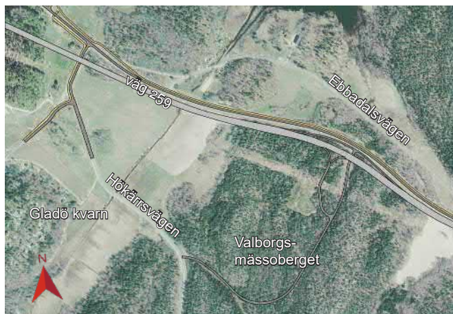
Figur 3.52 Trafikplats Gladö med kombinerad klöver- och ruterramper. Separat planskild koppling med lokalvägarna.
