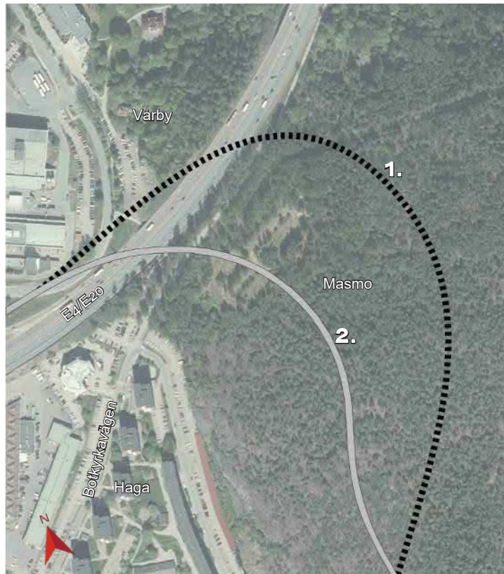
Figur 3.4 Studerade sträckningar av trafikplats Gömmarens ramp söderut. Alternativ med rampbro över E4/E20 visas med heldragen grå linje och alternativ med ramptunnel E4/E20 under visas med streckad svart linje.
