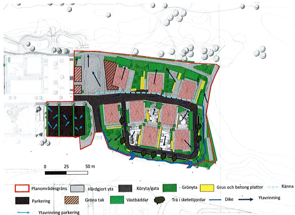
Figur 11. Systemskiss över potentiella dagvattenåtgärder.
