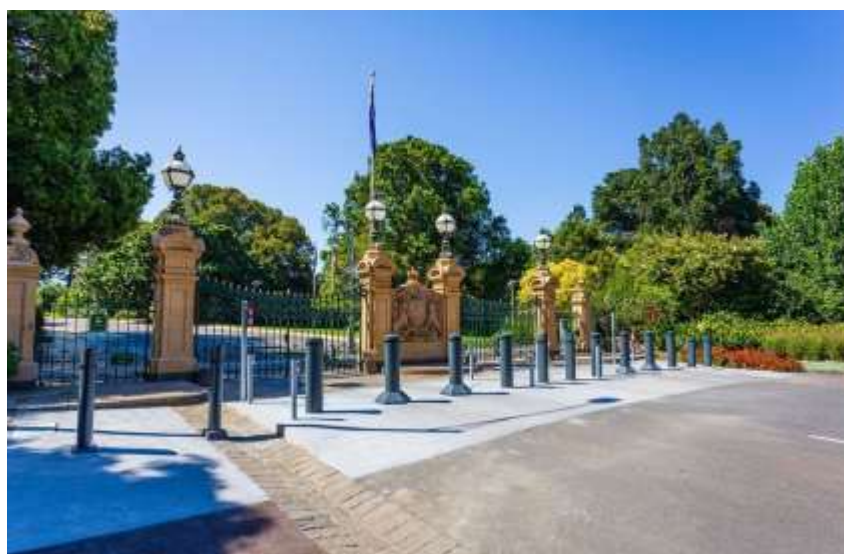
Pollarsystem Matador. Exempelbild från Storbritannien med en kombination av rörliga (två st. i mitten) och fasta pollare.
