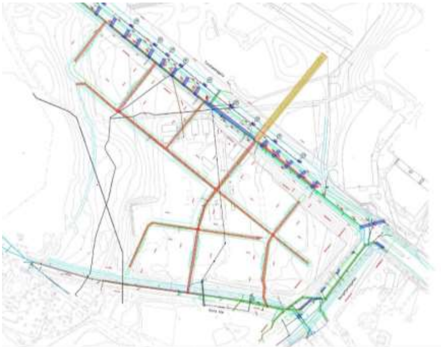
Figur 5 – Planerade ledningsdragningar inom området
