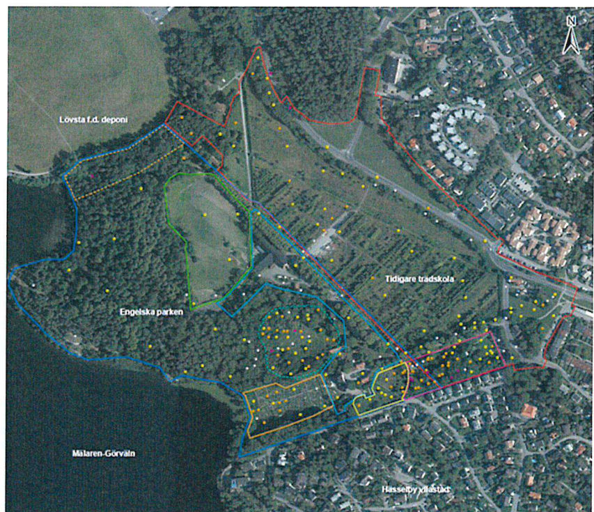
Figur 3. Lokalisering och klassning av uttagna miljöprover t.o.m. februari 2021 inom planområdet Riddersvik, mot Naturvårdsverkets generella riktvärden för jord (KM, MKM) samt farligt avfall. Se bilaga 2 för bättre upplösning.
