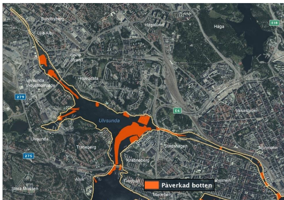
Figur 7. Bottenytor i Mälaren-Ulvsundasjön som identifierats vara påverkade med avseende på bottenstrukturs sammansättning. Kartan är upprättad efter den bottenkartering som Clinton Marine Survey gjorde 2018.
