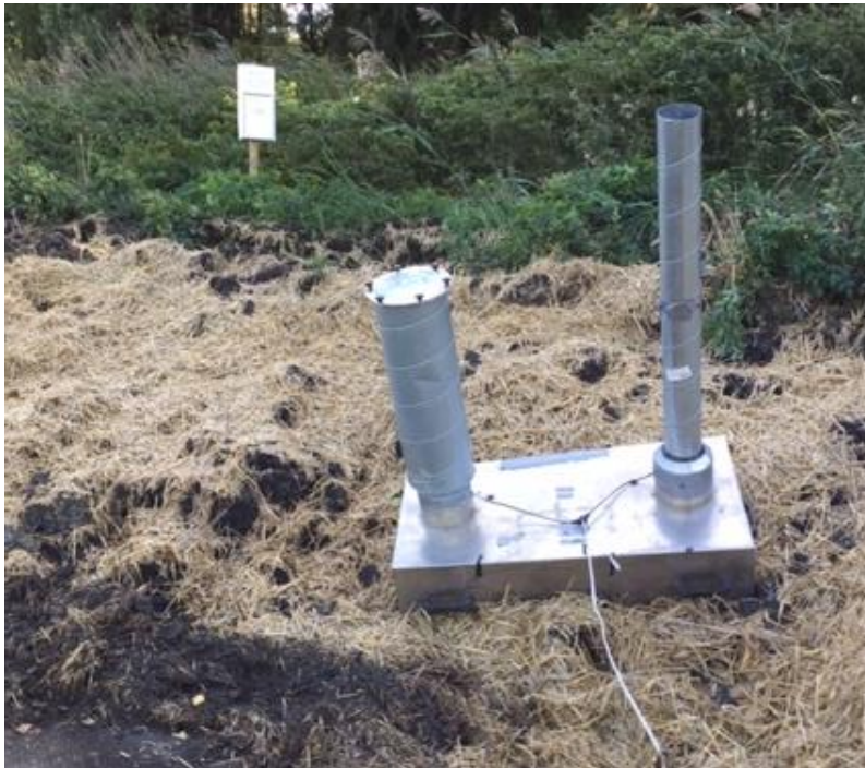
Figur 2 Provtagare på plats för att samla in luktprov.
