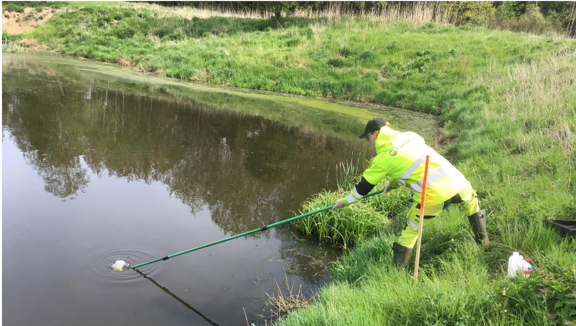
Figur 8 Uppmärkt provtagningspunkt, damm. Provtagning i dammen, viktigt att hålla provtagningskärlet med öppningen mot ytan för att undvika att få med mycket ytvatten vid provtagningen
