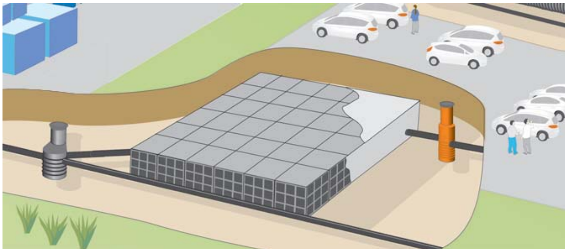
Dagvattenmagasin med dagvattenkassetter (Uponor).
