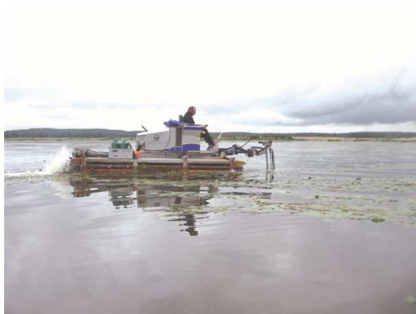
Figur 5. Klippningsmaskin anpassad för vattenväxter. Här klipps gul näckros ( Nuphar lutea ) i Asköviken.
