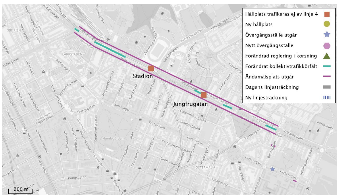
Figur 6. Översikt över föreslagna åtgärder i alternativet där kantstöd ej flyttas på delsträcka NORR.
