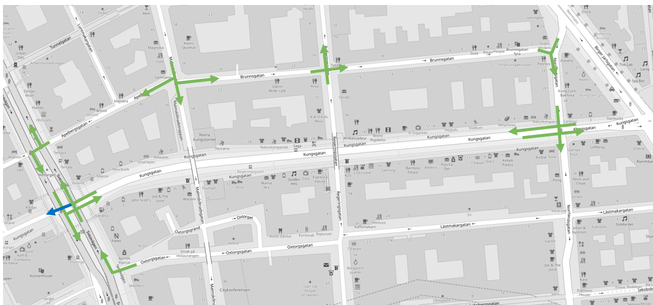
Figur 1. Visar dagens tillåtna svängrörelser för relevanta korsningar längs med Kungsgatan och närliggande studerat område för jämförelsealternativet (JA).
