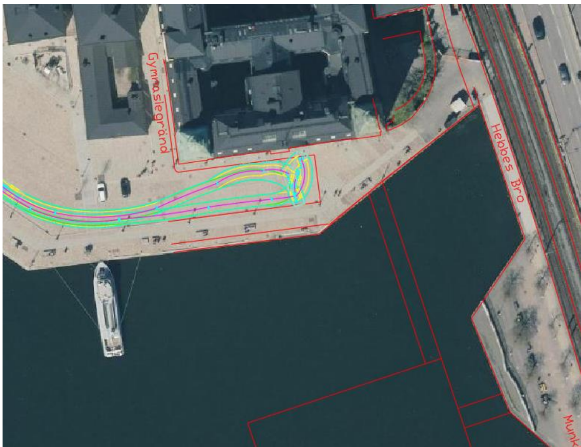
Figur 14: Körspår för backvändning med sobil vid befintlig vändyta
