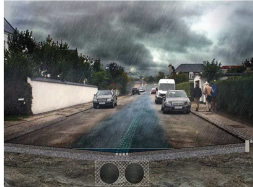
Exempel på mindre skyfallsled i urban miljö med en skyfallsväg som används både för fördröjning och transport av skyfallsvatten (Gentofte, Danmark). Källa: Ramboll
