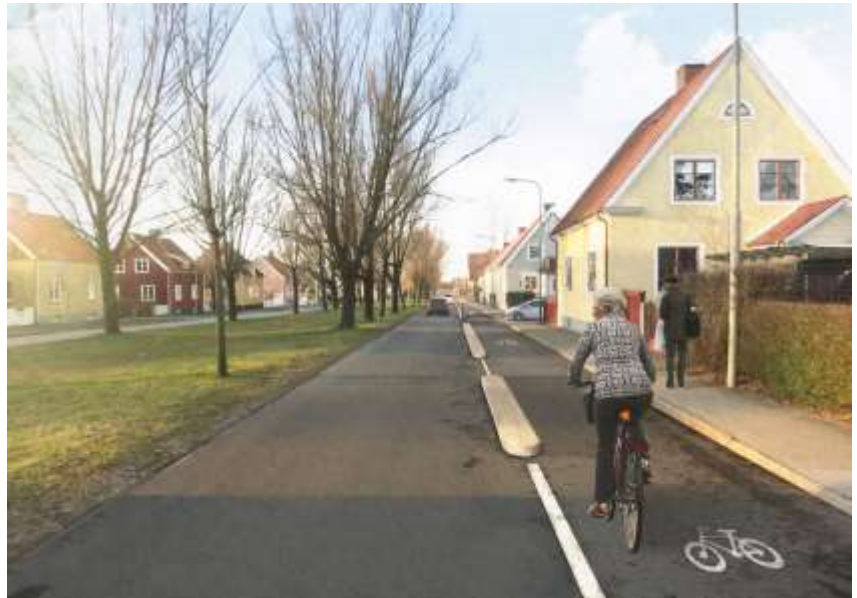
Figur 9. De nya planerade cykelbanorna som separeras mot biltrafiken med refugsten i granit
