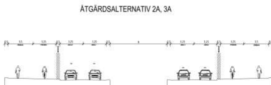
Figur 6. Normal brosektion till alternativen "ny bro" (åtgärdsalternativ 2A och 3A). Fri brobredd 13,25 m+13,25m och 8m mellan broarna.
