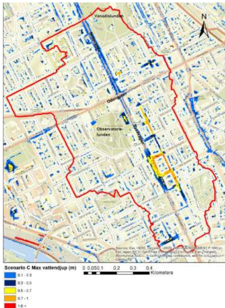
Figur 1: Kartbilden redovisar resultat från Stockholms stads skyfallsmodell, maximalt djup vid 100-årsregn. Ett område kring Rådmanngatans tunnelbanestation är i riskzonen för översvämning vid ett 100-årsregn, illustrerat i orange och rött.
