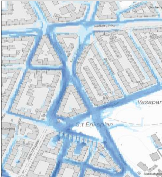
Figur 19. Flödeskarta för Sankt Eriksgatan och området kring Sankt Eriksplan visar på höga flöden på gatan.
