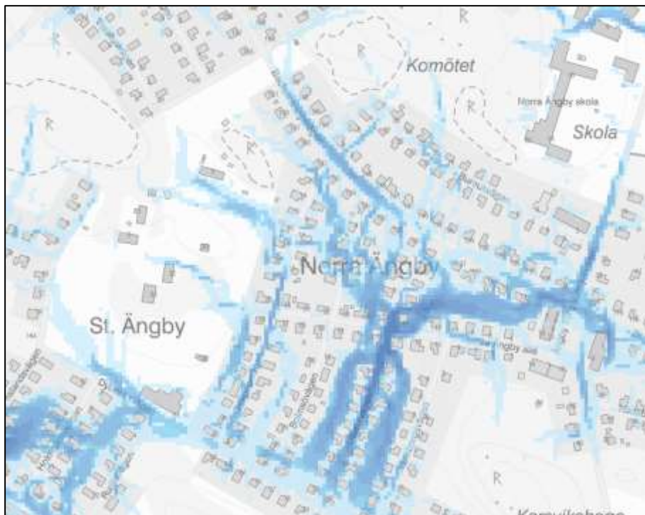
Figur 17. Flödesvägarna enligt skyfallskartan visar på stora mängder vatten som tar väg via området. Detta motiverar åtgärden ytterligare då man kan hindra mycket vatten att ta sig vidare ned mot Dybecksvägen där det enligt skyfallsmodelleringen riskerar att bli mycket vatten stående vid skyfall, se Figur 18.
