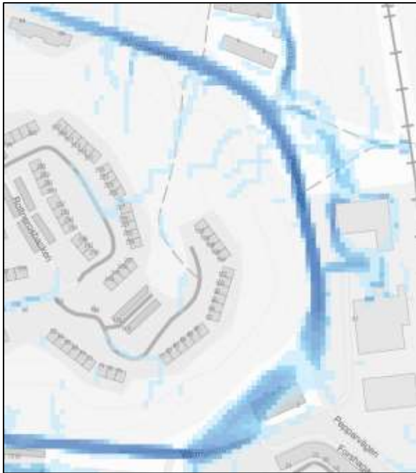
Figur 11. Flödesvägarna enligt skyfallskartan som visar att stora mängder vatten kan rinna längs med gatan.
