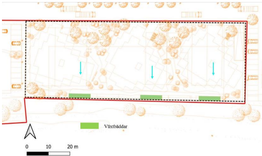
Figur 19. Systemskiss över potentiella dagvattenåtgärder inom kvarter 5.
