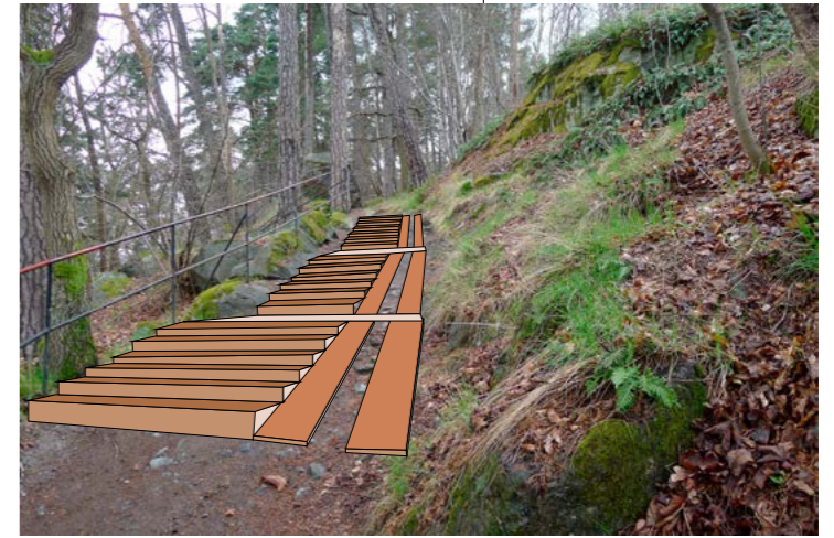
A. Trappramp av trä ersätts av trappor
