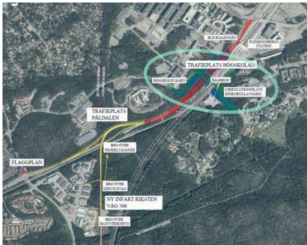
Bild 1. Översiktlig omfattning av vägplanen (gul och röd markering) och detaljplanen (grön markering). Turkos markering redovisar ungefärligt område för var SVOAs befintliga VA-anläggningar påverkas.
