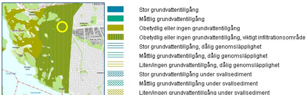
Figur 6. Utdrag från Stockholms stads karttjänst avseende klassificering av grundvattenförekomster i grus- och sandavlagringar. Lokaliseringen vid Skrubba representeras av en gul cirkel. Som framgår av figuren är Skrubba belägen inom ett område med obetydlig eller ingen grundvattentillgång och som utgör ett viktigt infiltrationsområde.
